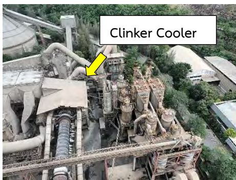
รูปที่ 2-27 ท่อนำความร้อนจาก P/H Boiler และ Clinker Cooler โรงงาน 3 (สายการผลิตที่ 5 และ 6)
