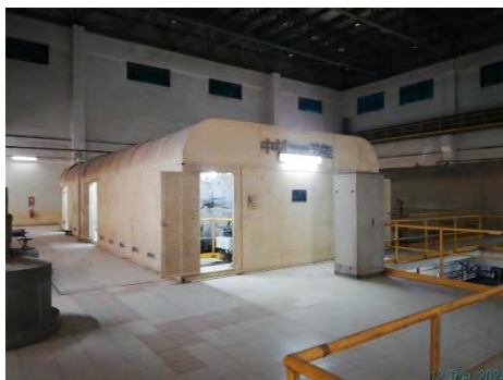
รูปที่ 2-32 อาคารปิดคลุมเครื่องจักรที่มีเสียงดังภายในพื้นที่โรงงาน 3 (สายการผลิตที่ 5 และ 6)
